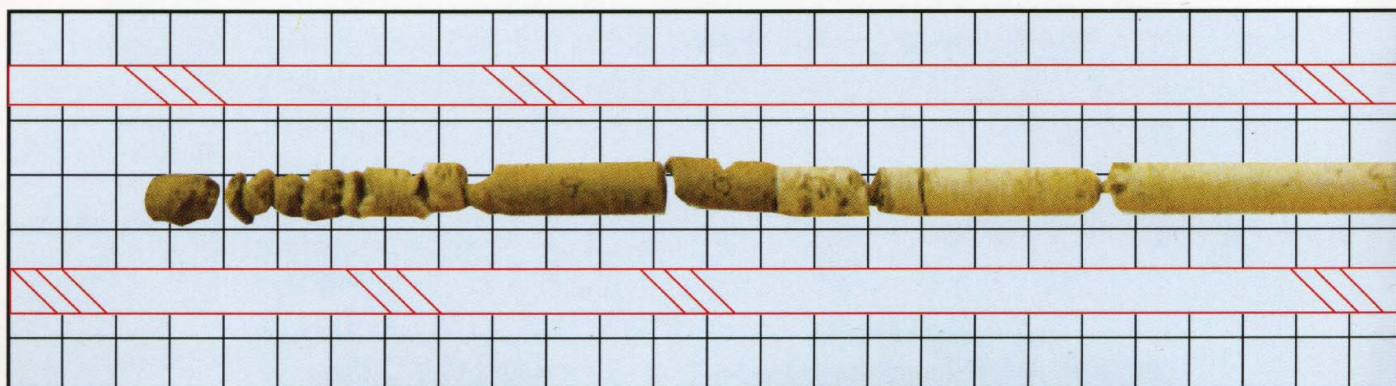
● 拡大球根の強度 くい先端に築造した球根の圧縮強度は20~30N/mm 2 と強固です。
